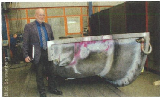
Dr.-Ing. Thomas Beck vor einem Pumpensaugkrümmer von den Schluchseewerken, der nach jahrzehntelangem Einsatz nun bei Kinkele geprüft wird.
