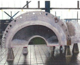
Die Messaufgabe an dieser Stelle war, den Istzustand des Pumpensaugkrümmers zu dokumentieren. Die Schluchseewerk AG will ein neues Teil bauen und benötigt dafür die CAD-Daten. Daraus macht sie sich ein CAD-Modell und lässt es von Kinkele nacharbeiten.
